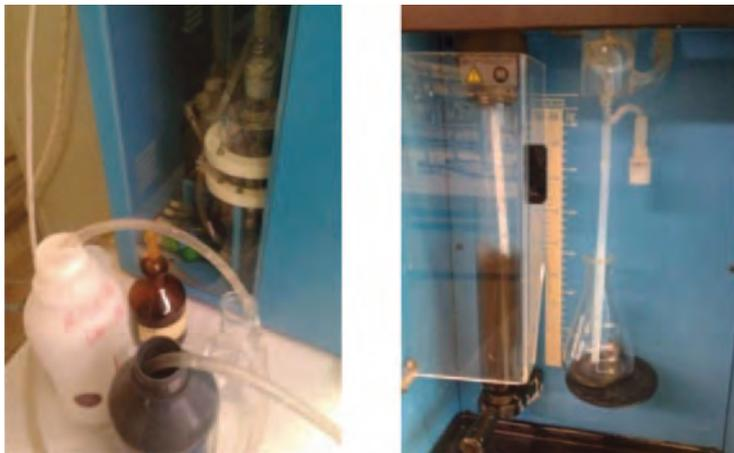
**Figura 9.** Distillazione in controcorrente
