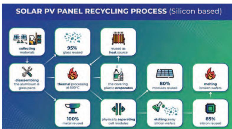
**Figura 6.** Processo di riciclo dei pannelli fotovoltaici
