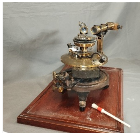
Figura 2. Spettrogoniometro Hildebrand früher August Lingke & Co. Freiberg 1892; fase di raccolta fotografica dello strumento, con e senza teca, e verifica dello stato di conservazione
