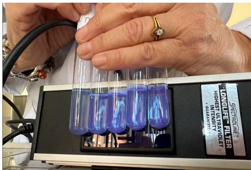
Figura 9. Campioni di estratto acquoso di ficocianina con diluizione 1:10 denaturati con etanolo a differente concentrazione; da destra verso sinistra, si nota la persistente fluorescenza azzurra all'aumentare della concentrazione di etanolo aggiunto (0%, 15%, 30%, 50%, 96%)
