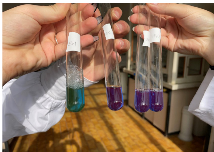
Figura 11. Campioni di estratto acquoso di ficocianina denaturati con soluzioni di urea a concentrazioni crescenti (0M, 3M, 6M, 8M); da destra verso sinistra, all'aumentare della concentrazione di urea, si nota il cambiamento di colore solo nel campione con aggiunta di urea 8M
