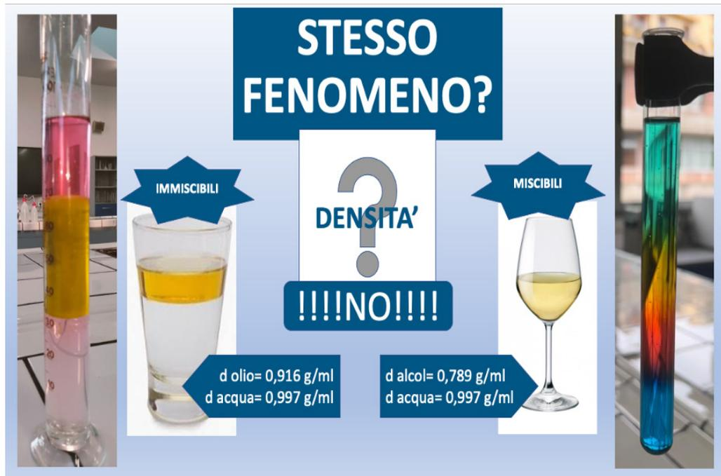
**Figura 3.** Densità vs. natura chimica: sulla sinistra una miscela eterogenea di liquidi ottenuti grazie alla diversa densità e natura chimica, sulla destra una provetta contenente soluzioni saline di NaCl colorate con colorante alimentare stratificate solamente grazie alla diversa densità (Laboratorio PLS “I.I.S. “G Ruffini” di Imperia)
