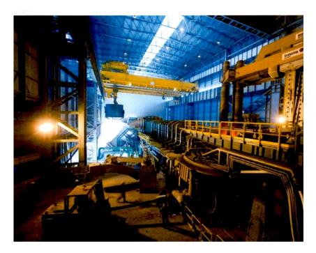
Figura 1. Forno elettrico ad arco
