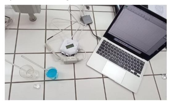
**Figura 5**. Setup sperimentale della Data Harvest per la misurazione di temperatura: una soluzione di CuSO<sub>4</sub>, una soluzione di NaCl e un foglietto di alluminio
