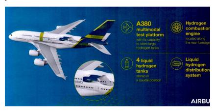
Figura 5. L'Airbus 380 che sta sperimentando il motore ad idrogeno
