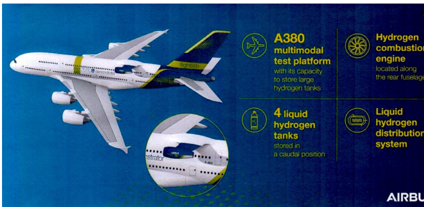
Figura 5. L'Airbus 380 che sta sperimentando il motore ad idrogeno
