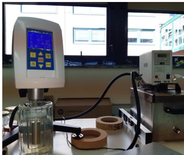
Fig. 3 Il viscosimetro Brookfield accoppiato al bagno termostatico
