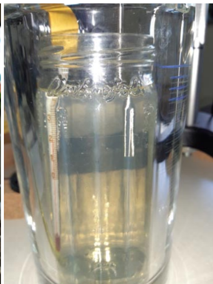
Fig. 9 L' hydrosol di gelatina a 21 °C
