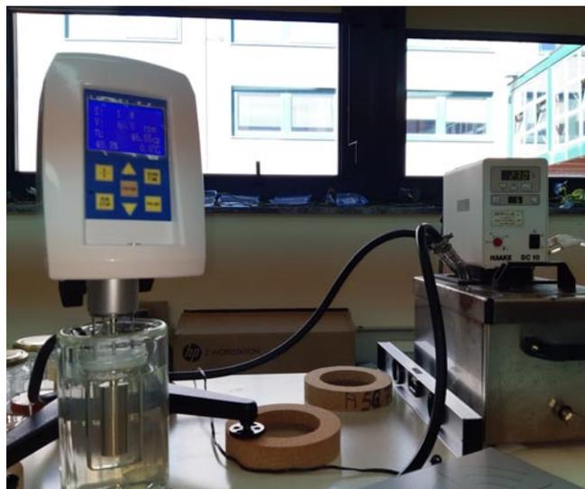
Fig. 3 Il viscosimetro Brookfield accoppiato al bagno termostatico
