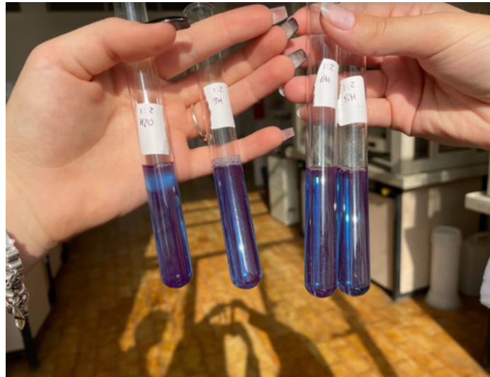
Figura 12. Campioni di estratto acquoso di ficocianina con diluizione 1:2, denaturati con soluzioni di urea a concentrazioni crescenti (0M, 3M, 6M, 8M), andando da sinistra verso destra
