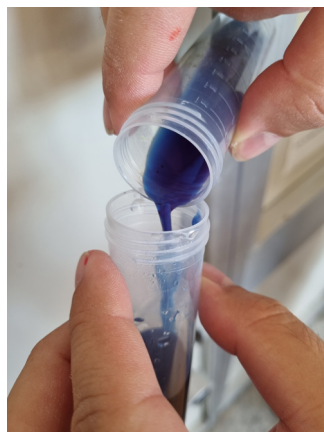
Figura 5. Separazione del surnatante blu brillante contenente la ficocianina
