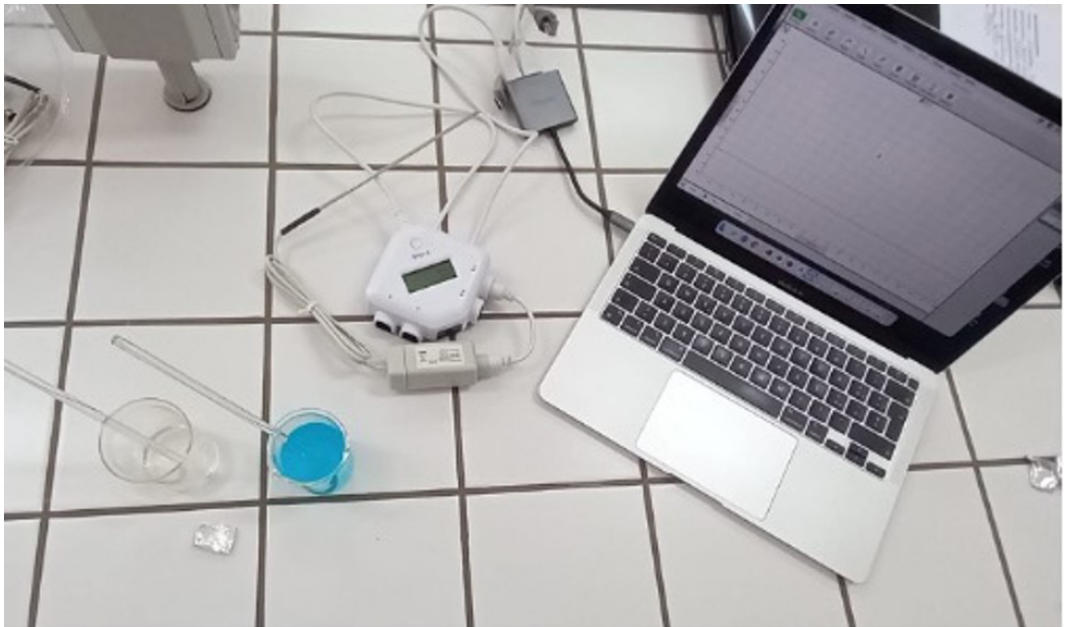
Figura 5. Setup sperimentale della Data Harvest per la misurazione di temperatura: una soluzione di \text{CuSO}_4 , una soluzione di \text{NaCl} e un foglietto di alluminio
