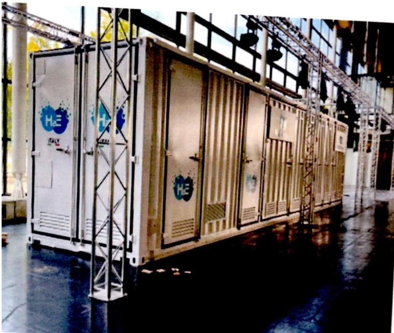
**Figura 2.** Apparecchiatura per la produzione di idrogeno per elettrolisi dell'acqua
