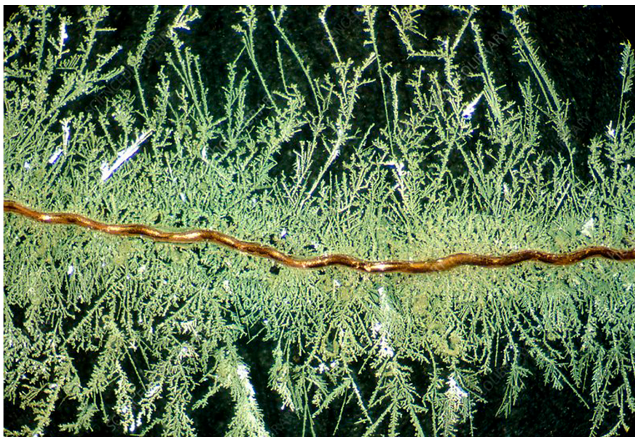
Figura 3. Crescita di cristalli di argento su filo di rame
