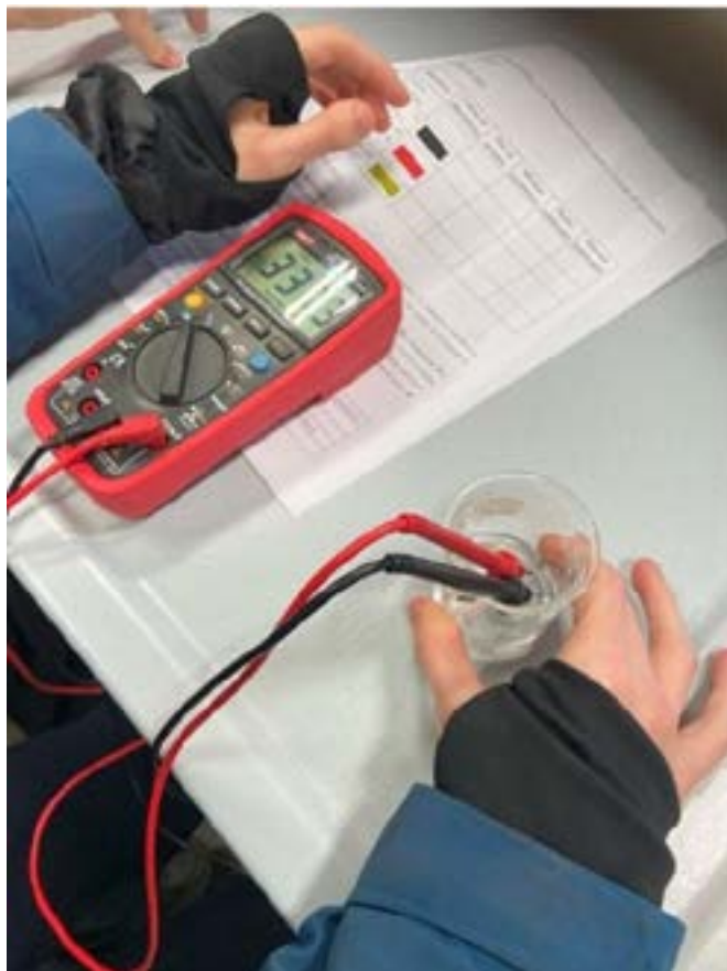
Figura 12. Utilizzo del Multimetro digitale per la misura della resistenza
